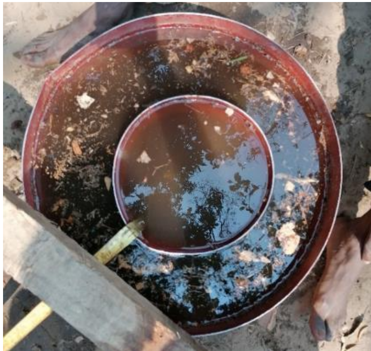
FIGURE 23 : Infiltromètre double anneaux utilisé
