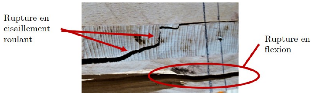
FIGURE 23 – Exemple de cisaillement roulant observé après essais (Photographie personnelle).
