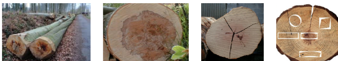
FIGURE 3 – Principaux défauts du hêtre : fibre torse, cœur rouge, fente et retrait (Crédits : B. Jourez, trois premières photos - quatrième image : [ https://constructionbois.bilp.fr ]).
