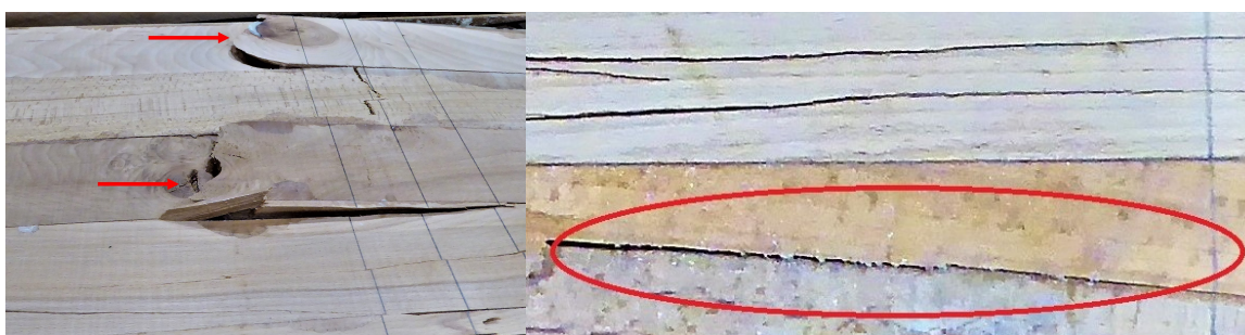
FIGURE 25 – Rupture au niveau de deux nœuds (gauche) et rupture suivant parfaitement la séparation entre le cœur rouge et le bois blanc (droite) (Photographies personnelles).
