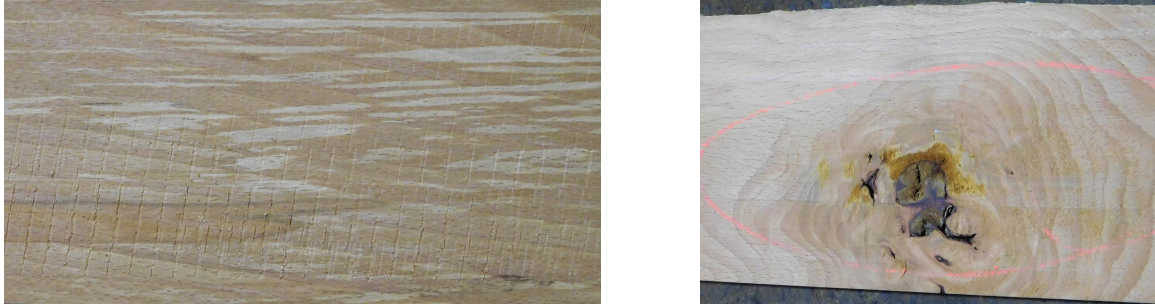
FIGURE 16 – Exemple d'échauffure (gauche) et de nœud (droite) (Photographies personnelles).
