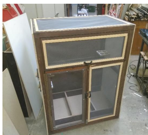
Figure 22 : Cage d'élevage construite
