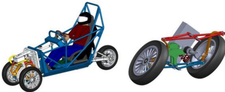
Optimisation dynamique d'un tricycle inclinable à vocation urbaine Gauche : véhicule complet – Droite : suspension avant en inclinaison max Thèse de doctorat d'Aubain Verlé, UCLouvain, 2018
