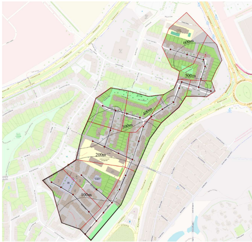
Figure 8-2: Réseau de conduites Marie d'Oignies avec isodistances.
