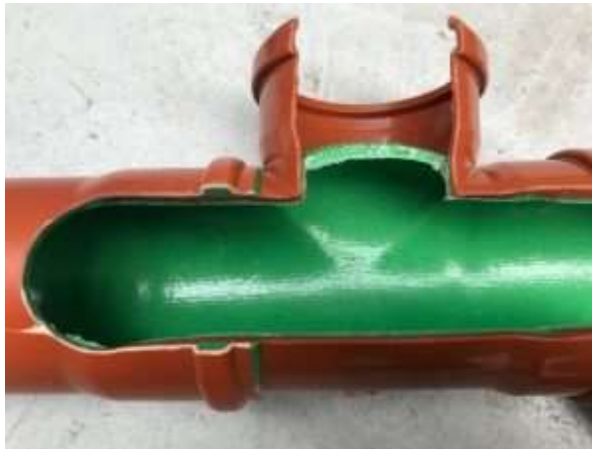
Figure 2-22: Exemple de chemisage d'une canalisation [53].
