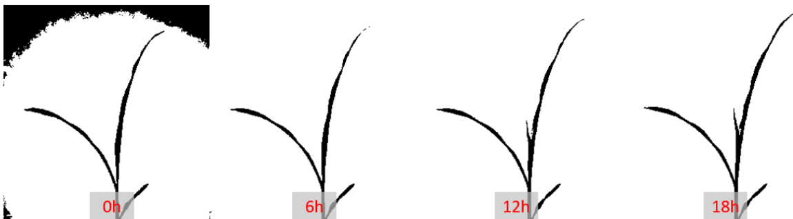
FIGURE 4.14 – figure 4.13 après application d'un filtre de seuillage après application d'un filtre de seuillage sur le canal K de l'espace de couleur CMYK
