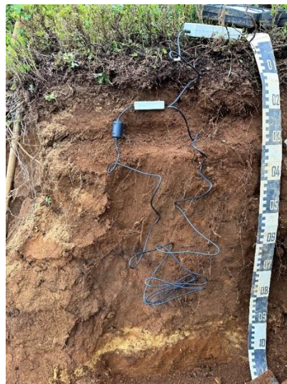
Figure 19 Profil du sol où les mesures TDR ont été prises sur le terrain
