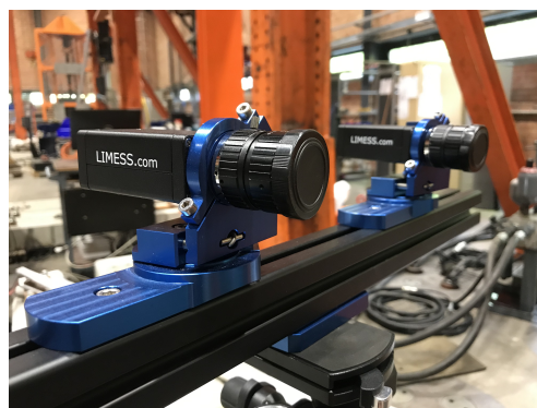
FIGURE 3.24 – Caméras utilisées pour la DIC
