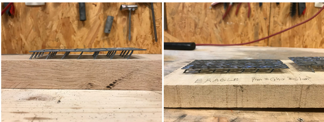
FIGURE 3.3 – Comportement des connecteurs de type BOVA dans du : hêtre (gauche) et de l'érable (droite)
