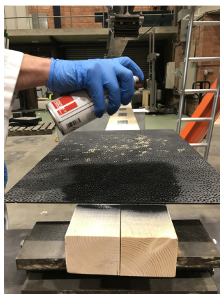
(a) Application d'une couche de granite noir
