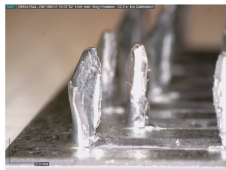
(b) Dents du connecteur MITEK
