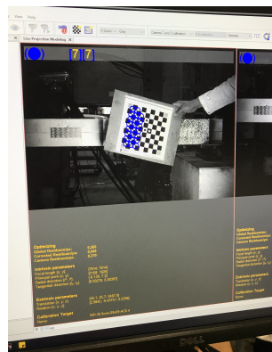
(b) Calibration du logiciel grâce à la grille
