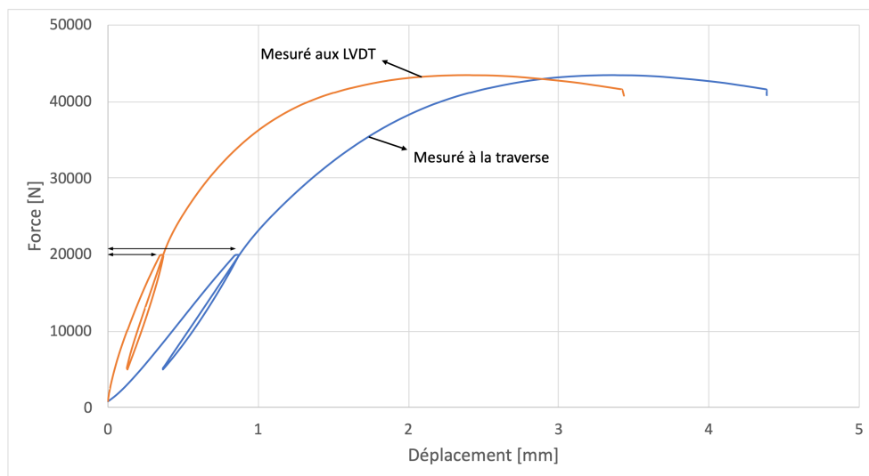
FIGURE 3.19 – Représentation des deux possibilités de mesure
