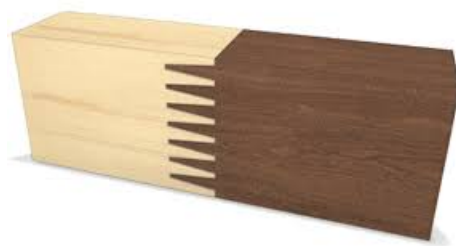
FIGURE 1.7 – Aboutage par entures multiples
