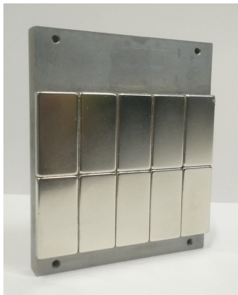
FIGURE 3.10 – Aimants collés sur la pièce de fer
