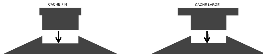
Figure 30 : schémas de la mise en place des deux types de caches dans l'encoche du séparateur ABS.
