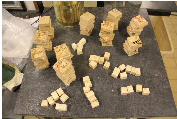
FIGURE 4.4 – échantillons réalisés afin de déterminer la masse volumique et teneur en eau du bois et panneaux d'OSB
