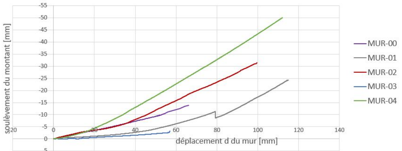
FIGURE 4.2 – soulèvement du montant sous le vérin durant l'essai en fonction de la déformation du mur d
