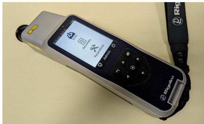
Figure 22 : Spectromètre Raman portable (Rigaku Progeny)
