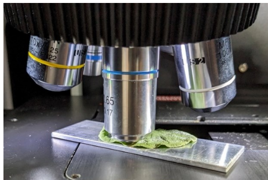
Figure 36 : Analyse directe de la feuille d'épinard de la méthode 3 avec le microscope Raman Senterra II
