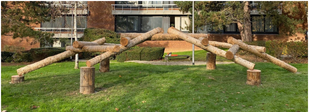
Figure 27 : Structure réciproque par Justin Goosse [1]
