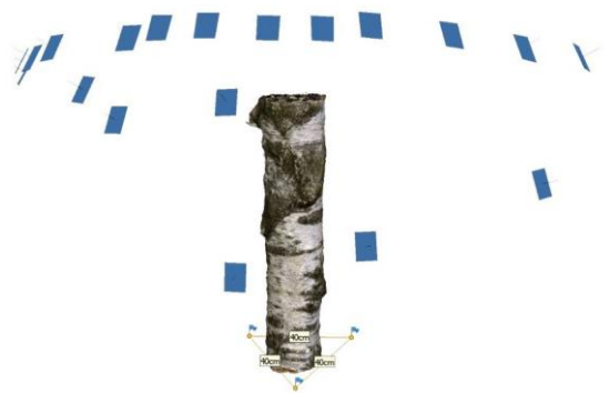
Figure 17 : Scan de la grume par photogrammétrie. [1]
