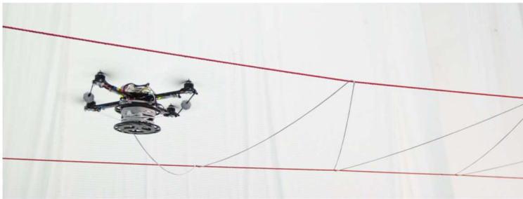
Figure 10 – Un drone construisant une structure avec un fil
