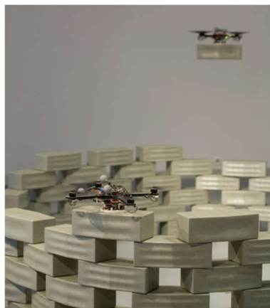
Figure 9 – A droite – Deux quadricoptères construisant la maquette avec des modules de 30 cm de long. [21]
