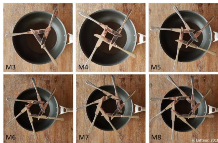
Figure 10 : Exemple de configuration de modules réciproques [14]
