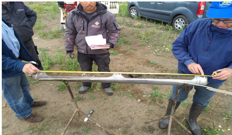
Figure 14: Echantillonnage (6 horizons) sur une carotte non-perturbée correspondant à un profil de sol de 1,2m.
