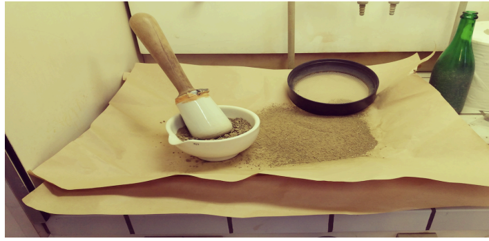
Figure 15: Pré-traitement par broyage au pilon, compression par la technique de la bouteille et passage au tamis de 2mm.
