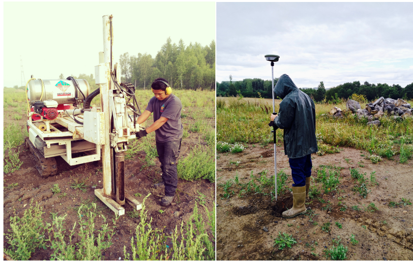
Figure 13: Extraction d'une carotte de sol à l'aide d'une sonde Geoprobe 540U (photo de gauche) et mesure des coordonnées géographiques à l'aide d'un récepteur GPS Leica (photo de droite)
