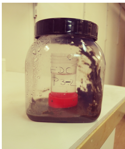
Figure 17: Milieu d'analyse respirométrique (Système clos contenant le sol réhumidifié et un flacon ouvert contenant une solution de NaOH)
