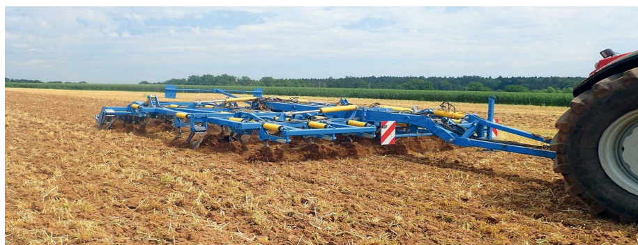
Figure 39: Cultivateur lourd à dents fines de type "Terrix" (Source: Farnet (Site Web))
