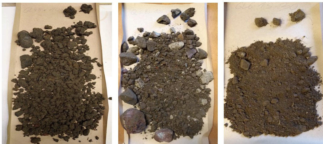
Figure 19: Terre fine et charge caillouteuse pour le site de GL. De gauche à droite: GL4 85-105; GL5 85-105; GL6 15-30.
