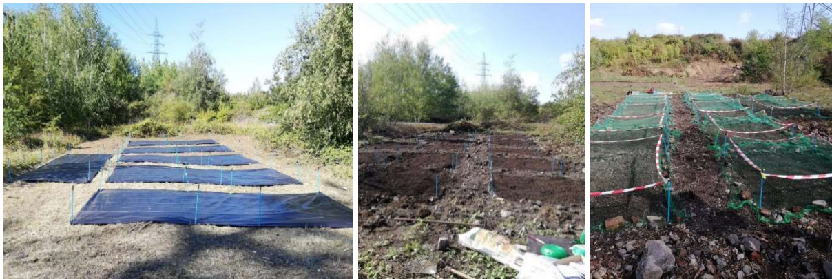
Figure 12 : a) Bâchage après déblayage (Blanquet 2020); b) Délimitation des parcelles et ratissage (Blanquet, 2020); c) Installation du ruban et des filets anti-oiseaux (Blanquet, 2020).
