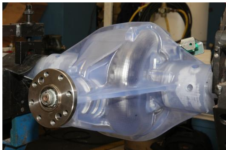
Figure 14. Prototype en plastique transparent.
