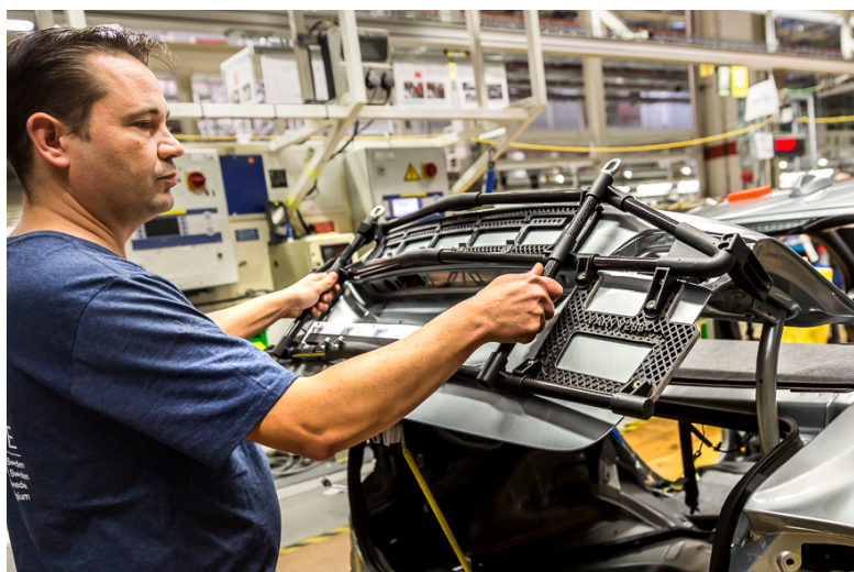
Figure 16. Gabarit Volvo imprimé en 3D.
