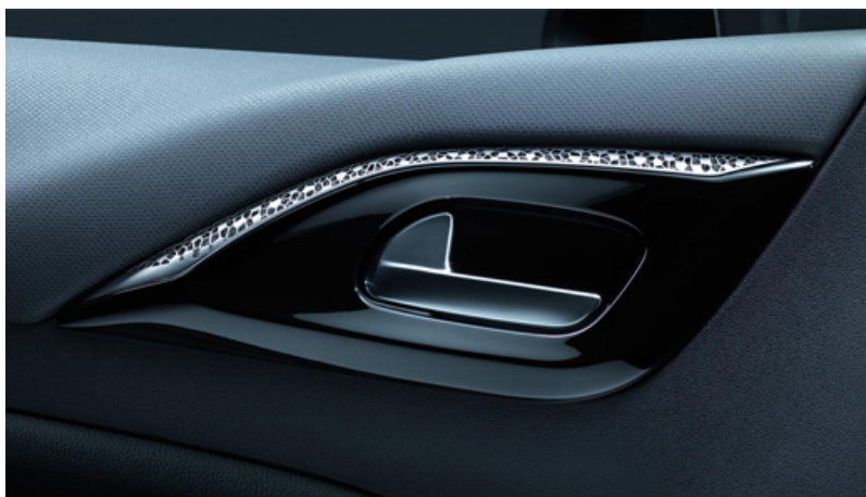
Figure 20. Contour de poignées de porte de la DS3 produit par AM.
