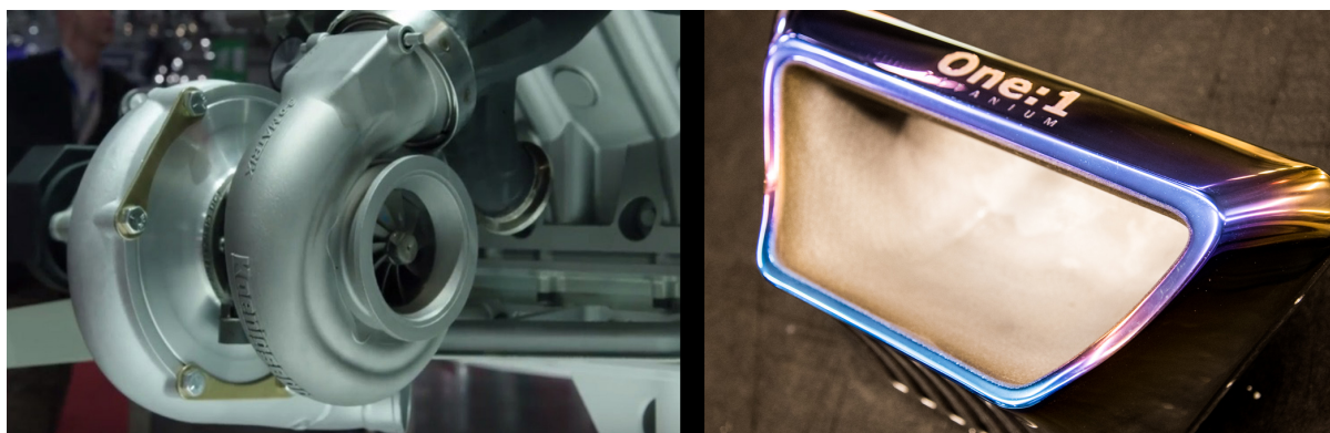
Figure 19. Composants de la Koenigsegg One:1 produits par AM.
