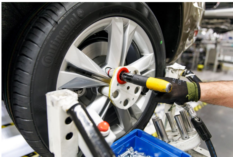
Figure 15. Détrompeur Volkswagen imprimé en 3D.
