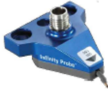
FIG. 10: Sonde infinity utilisée pour les mesures sur plaquette
