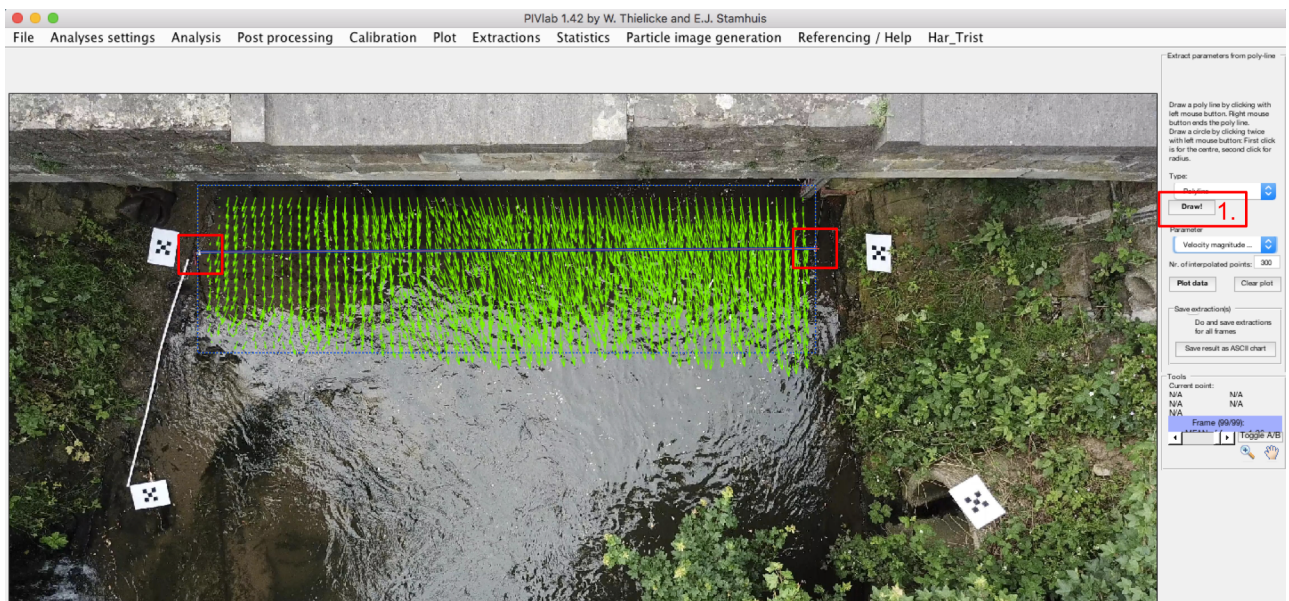
FIGURE 7.2 – PIVlab : menu " Extractions ". Au centre des deux encadrés rouges se trouvent les repères placés aux extrémités des mesures effectuées avec le courantomètre, afin de comparer les résultats du courantomètre et de l'analyse PIV sur des sections de même dimension.
