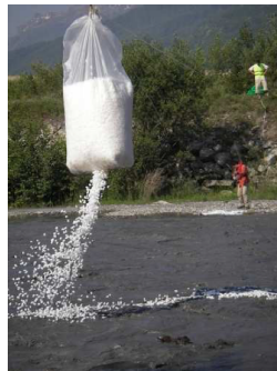
FIGURE 3.2 – Système de tyrolienne utilisé par A. Hauet [5] pour ensemençer la rivière.
