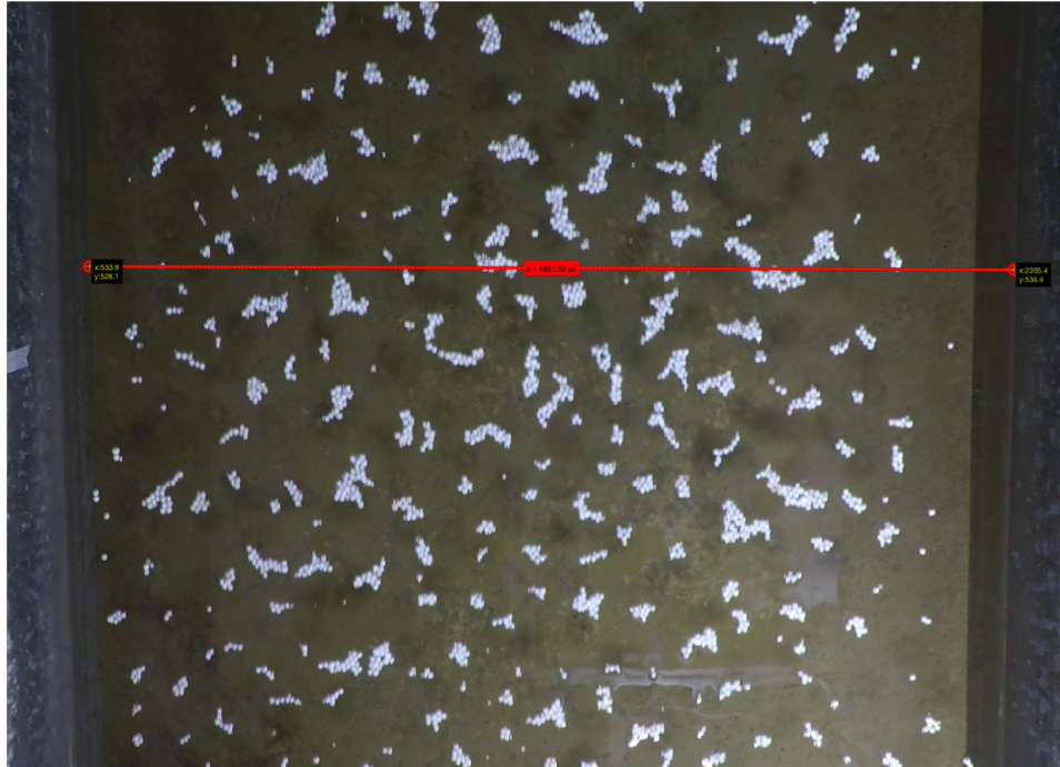
FIGURE 2.14 – Exemple de calibration sur image de labo. Ici, la largeur du canal est connue et sert pour la calibration
