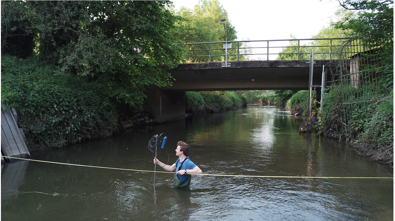
FIGURE 7.1 – Prise de mesure à intervalles réguliers le long d'une section avec le courantomètre OTT MF Pro
