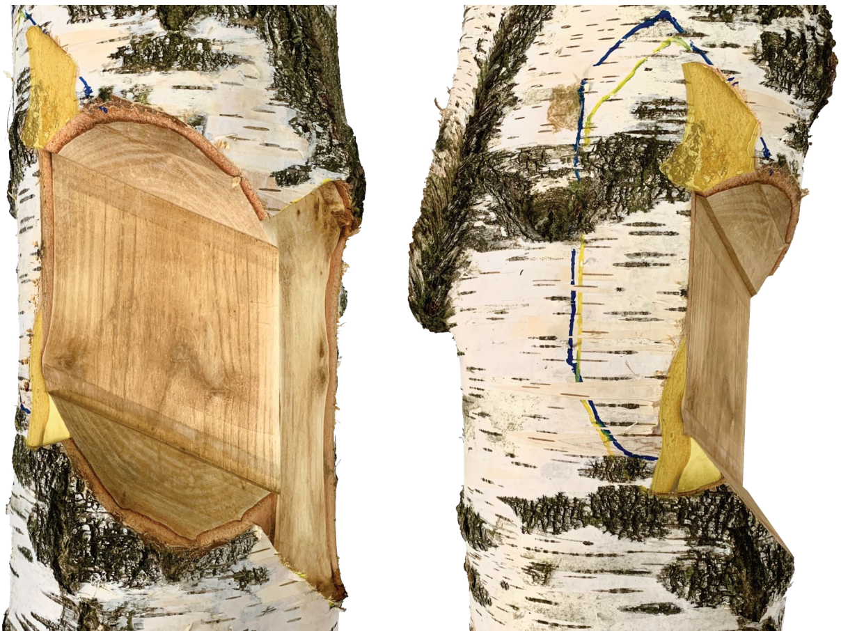
Figure 23 : Défaut d'usinage lors des premiers essais
