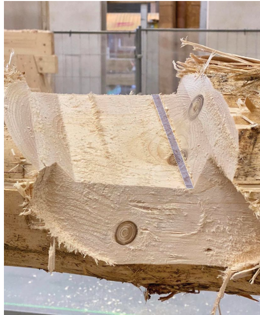
Figure 81 : Décalage de 8 [mm] du plan incliné de droite de la découpe principale, en bleu
