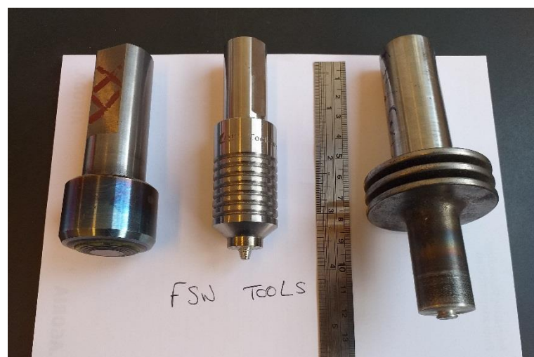
Figure 3 - Exemple d'outil servant à des soudures de type FSW
