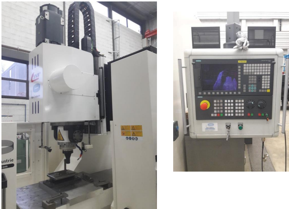
Figure 13 – Gauche : photo de l'espace de travail de la machine FSW. Droite : boîtier de contrôle où le code était modifié, les données/graphiques observés.
