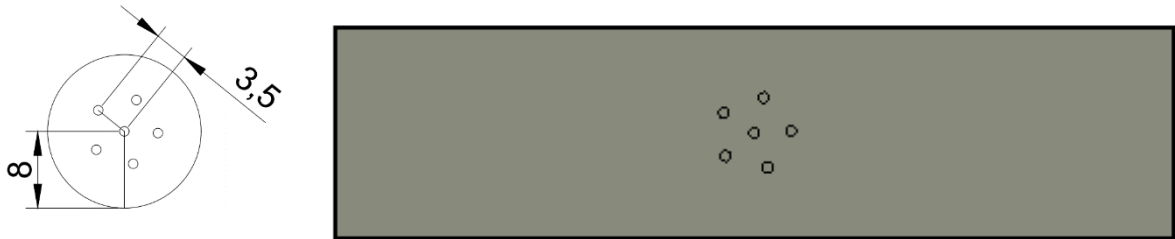
Figure 12 – Gauche : Configuration des trous de 1 [mm] percés dans la plaque d'acier. Les dimensions sont en millimètres. Le cercle extérieur représente le diamètre de l'outil de soudure. Droite : modèle à l'échelle d'une plaque d'acier percée.
