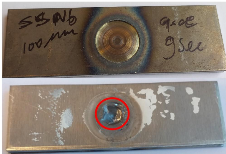
Figure 19 - Soudure SSN06 : première soudure avec plaque de support en acier. L'arrière de la soudure laisse apparaître un creux dans l'aluminium comme s'il s'était en partie évaporé.
