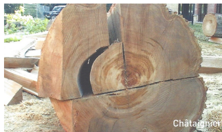
FIGURE 2.14 – Roulure observée sur une section transversale [36]
