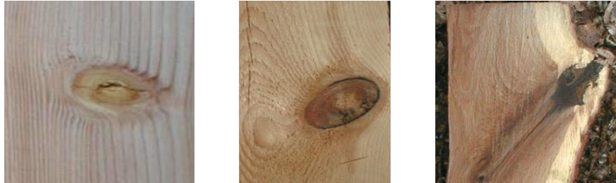
FIGURE 2.13 – De gauche à droite : Nœud adhérent, nœud mort et nœud pourri [6]
