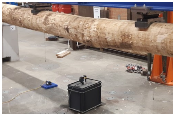
FIGURE 3.24 – Dispositif de mesure de la flèche centrale
