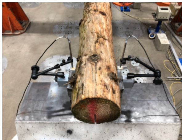
FIGURE 3.26 – Disposition d'un LVDT [2]
