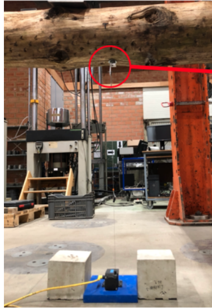
FIGURE 3.25 – Disposition d'un potentiomètre [2]
