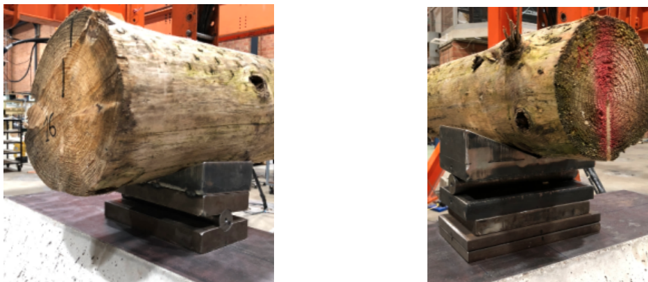
FIGURE 3.21 – Appuis du gros (gauche) et petit (droite) bout [2]
