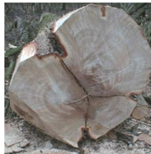
FIGURE 2.18 – Cadranure ou cœur étoilé d'une section [36]
