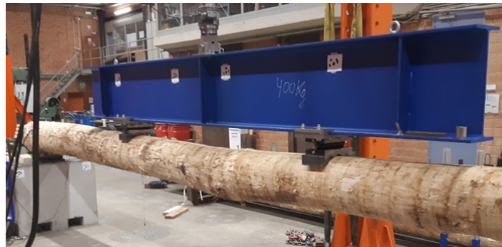
FIGURE 3.20 – Poutre de répartition du banc d'essai
