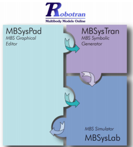
FIGURE 2.5 – Diagramme de fonctionnement de ROBOTRAN. Adapté de [18]
