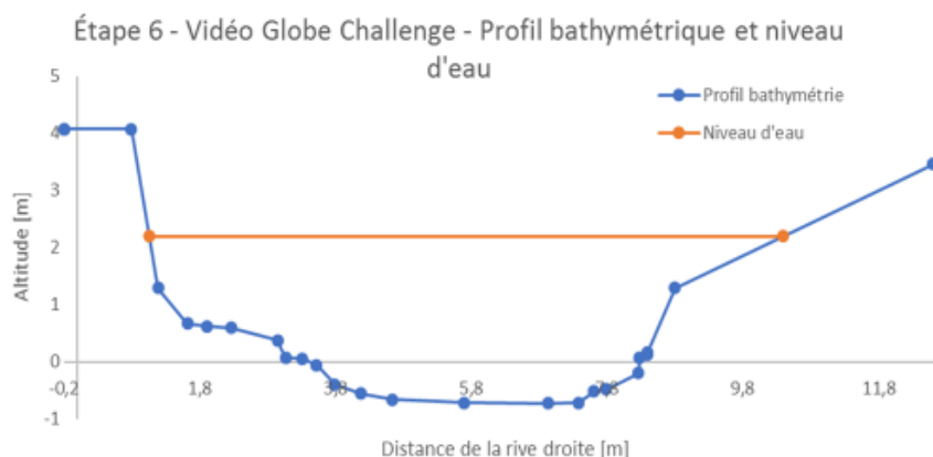
FIGURE 3-3 – PROFIL BATHYMETRIQUE ET NIVEAU D'EAU – CHALLENGE N°6
