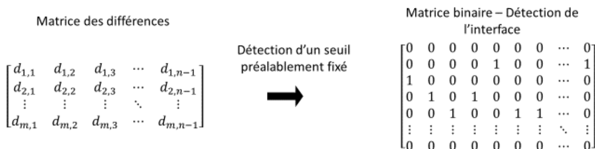
FIGURE 4-7 – CRÉATION D'UNE MATRICE BINAIRE APRÈS DÉTECTION DE LA VALEUR SEUIL
