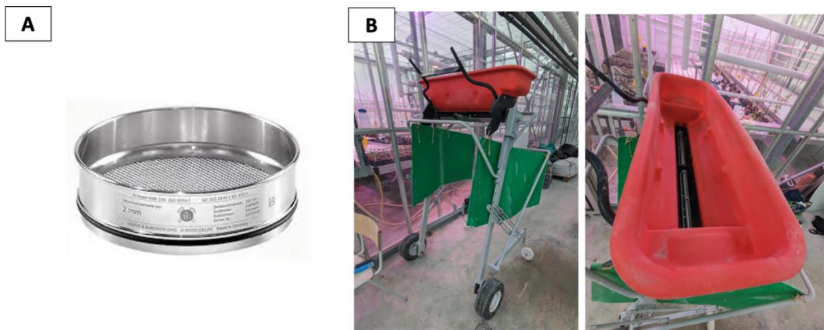
Figure 13 : Photos du tamis d'une maille de 4 mm (A) et de l'épandeur de téphra utilisé pour appliquer le téphra sur la culture de riz (B), avec les bâches rigides aux extrémités. L'épandeur de téphra se compose d'un bac à téphra installé sur épandeur de sel roulant positionné à 1,5m au-dessus du sol.
