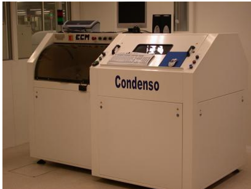
Figure 18. Illustration de l'équipement de production brasant les composants sur les cartes.
