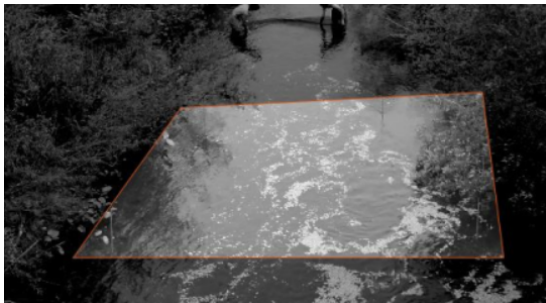
FIGURE 2.9 – Région d'intérêt sélectionnée pour l'orthorectification [21]
