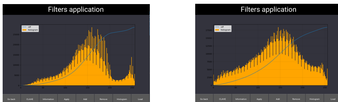
FIGURE 8.13 – Histogramme des intensités des pixels avant et après l'application du filtre CLAHE
