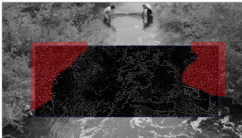
FIGURE 2.6 – Région d'intérêt (zone noire) et masques (zones rouges) choisi, après application des filtres [21]
