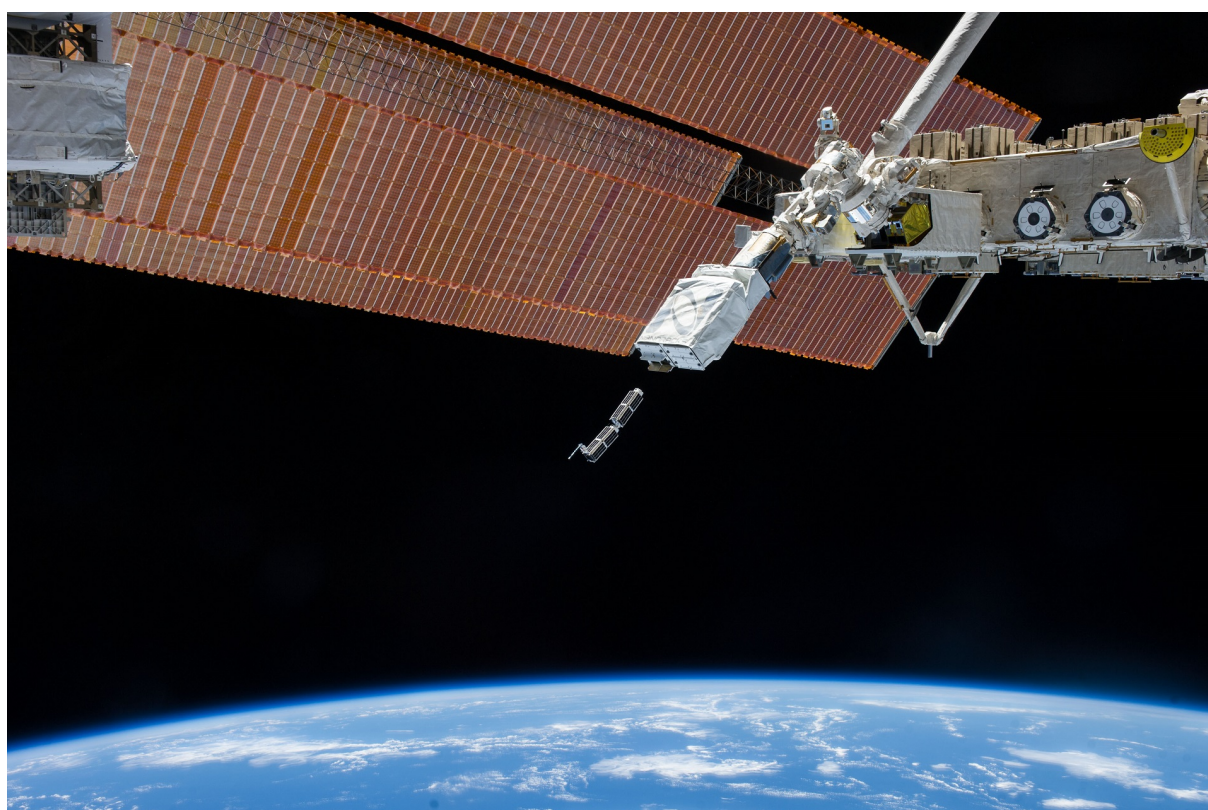
FIGURE 49 – Déploiement de nanosats via NanoRacks à bord de l'ISS
