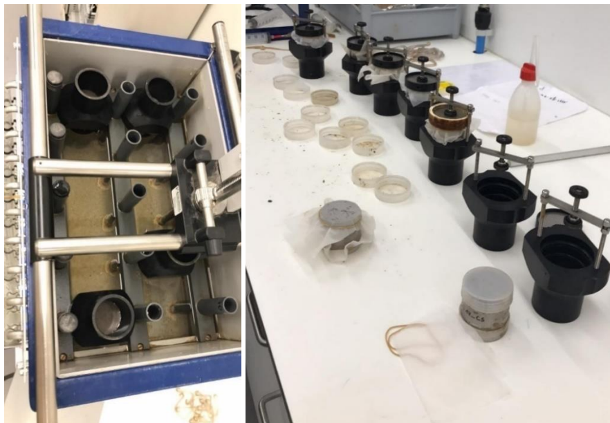
Figure 30 : Photo de l'intérieur du perméamètre (à gauche) et de la préparation des échantillons (à droite)
