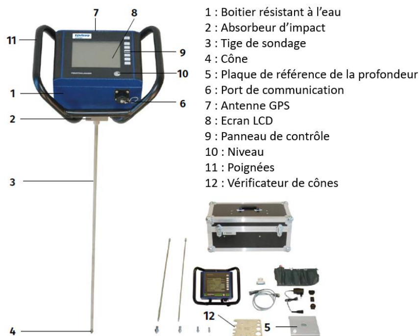
Figure 15 : Différentes parties du pénétromètre (Royal Eijkelkamp, 2022)
