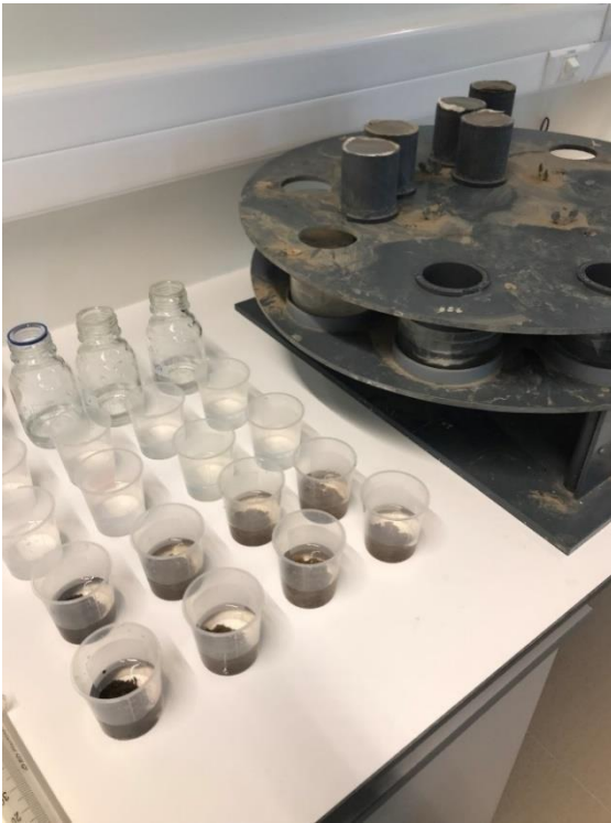
Figure 31 : Photo du traitement « Désagrégation mécanique » du test de Le Bissonnais (à gauche) et instrument permettant de mélanger les agrégats dans de l'éthanol à la fin de chaque traitement de Le Bissonnais (à droite)
