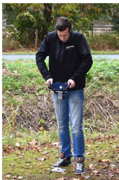
Figure 16 : Mise en pratique du pénétromètre sur le terrain (Royal Eijkelkamp, 2022)
