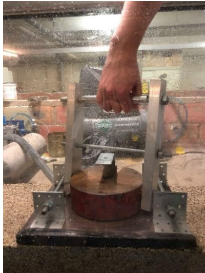
Figure 3.4 : Système permettant de tasser le lit de sédiment de manière uniforme.
