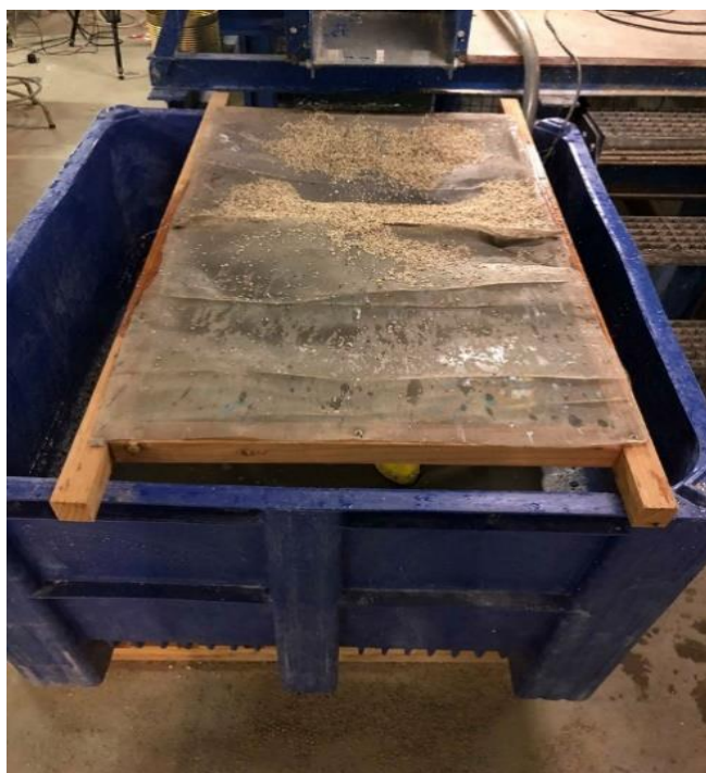
Figure 5.35 : Tamis permettant de retenir les sédiments arrachés durant une expérience.
