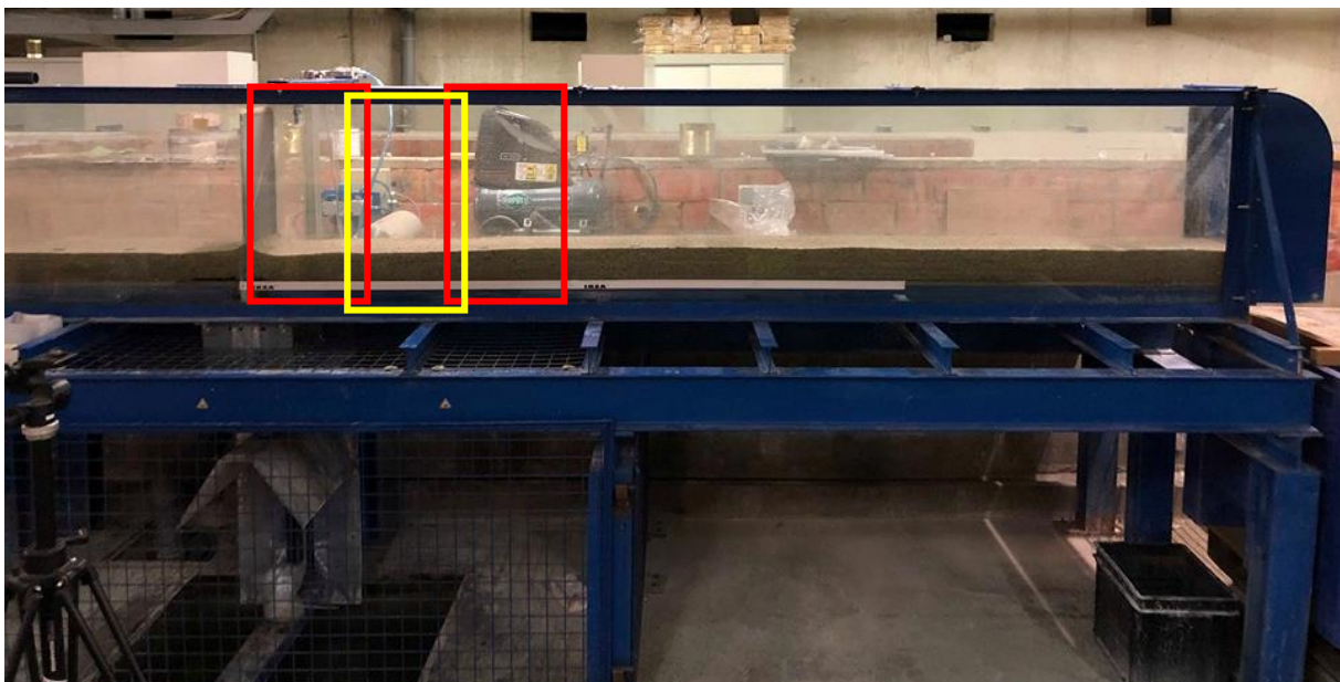
Figure 3.5 : Canal de rupture de barrage du laboratoire d'hydraulique de l'UCL avec les différentes positions du laser et de la caméra pour enregistrer les expériences à 17 cm, 45 cm et 75 cm de la porte (cadres colorés de gauche à droite).
