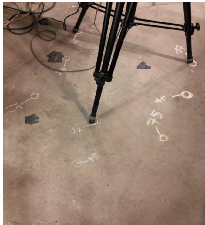
Figure 5.37 : Marques au sol afin de retenir l'emplacement du trépied.
