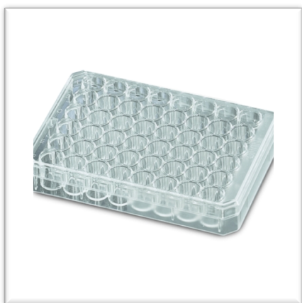
Figure 16 Photo d'une boîte microplaques utilisée pour le design. Chaque colonne (numéro) correspond à un rhizoslides. Dans chaque compartiment sont stockés 6 graines d'un même génotype. La dernière colonne a été laissée vide pour le besoin du design.
