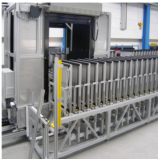
Figure 13 Dispositif automatisé pour le screening des rhizotrons (mk technology group, 2018)
