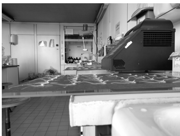
Figure 19 Photo prise de profil d'un rhizoslide. Nous pouvons observer que les racines ne poussent pas tout à fait dans le plan de la plaque
