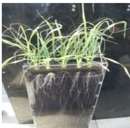
Figure 11 Exemple d'un rhizotron (Institut für Bio- und Geowissenschaften/Pflanzenwissenschaften (IBG-2), 2013)
