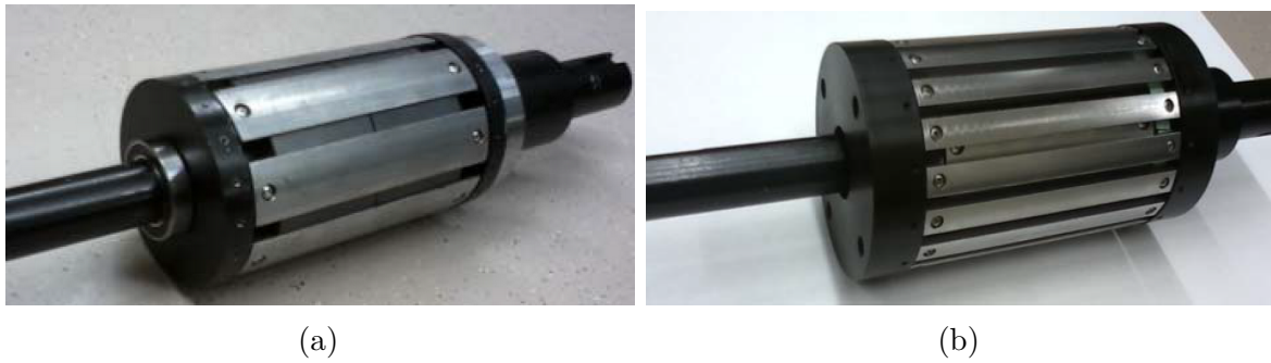
FIGURE 2.11 – Prototype [36] : (a) rotor haute vitesse, (b) pièces polaires et leurs supports.
