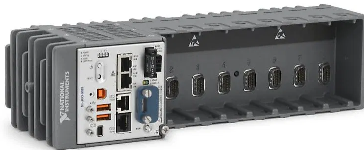
FIGURE 3.14 – compactRIO de National Instrument, à droite, les slots pour les cartes d'extension
