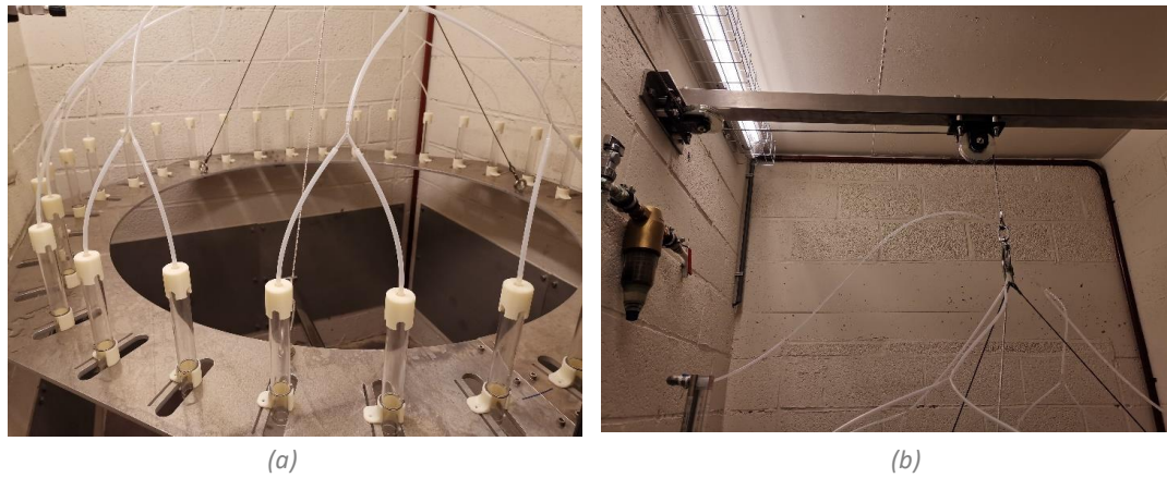
Figure 9 : (a) Anneau avec pipettes d'eau (b) Raccordement débitmètre-anneau
