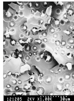
FIGURE 2.54 – Observation au SEM du faciès de rupture d'une résine additivée de thermoplastique ayant subi un pontage des fissures [73].
