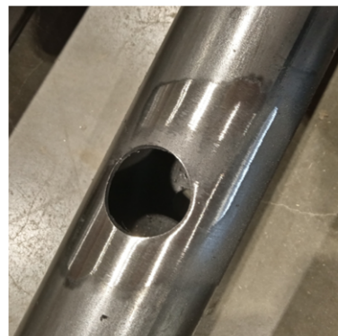
Figure 5.12: Mèche étagée et élargissement du premier percement
