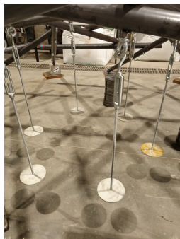
Figure 5.19: Suspentes fixées aux vis
