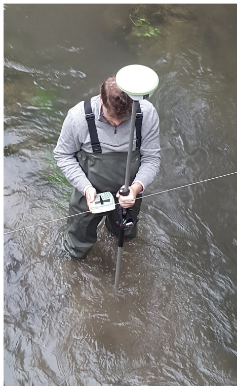
FIGURE 2.10 – Acquisition d’une section bathymétrique sur le Train.
