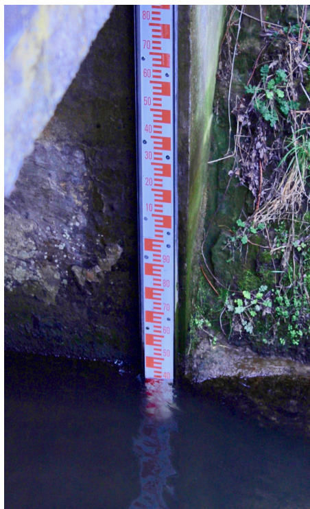
FIGURE 2.4 – Station d’Archennes sur le Train : échelle limnimétrique.
