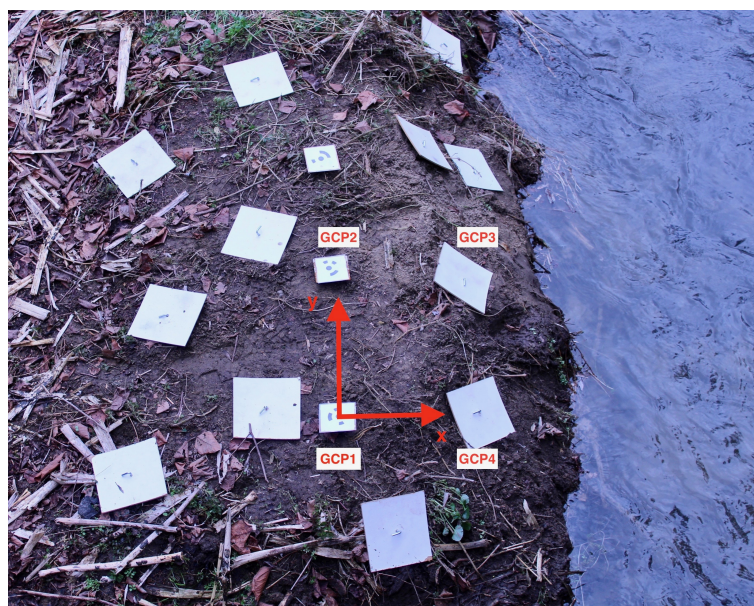
FIGURE 2.7 – GCPs sur le Train : disposition et repère local.
