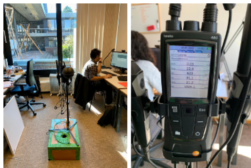
FIGURE 1: Centrale d'acquisition TESTO 480
