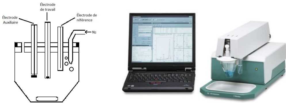
Figure 12: A gauche : schéma simplifié du dispositif (Wang, 2006). A droite : Illustration du polarographe relié à un ordinateur pour traitement des données (Metrohm.com)
