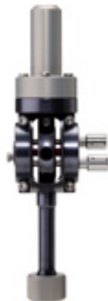
Figure 3.6: Schéma du montage en cisaillement du DMA [22]
