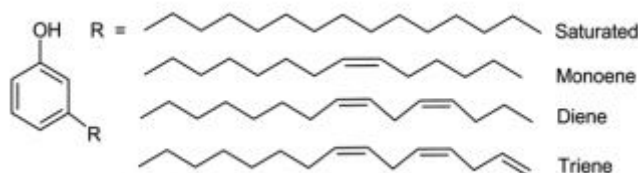
Figure 2.11: Structure d'une molécule cardanol [7].
