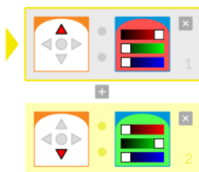
FIGURE 2.6 – Feedback visuel offert par la programmation VPL (avec la flèche jaune, l’instruction en train d’être exécutée)
