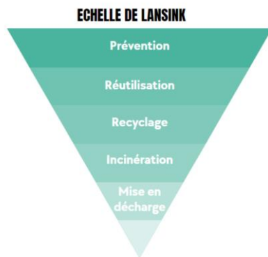
Figure 4 – L'échelle de Lansink (Région Wallonne, 2022)
