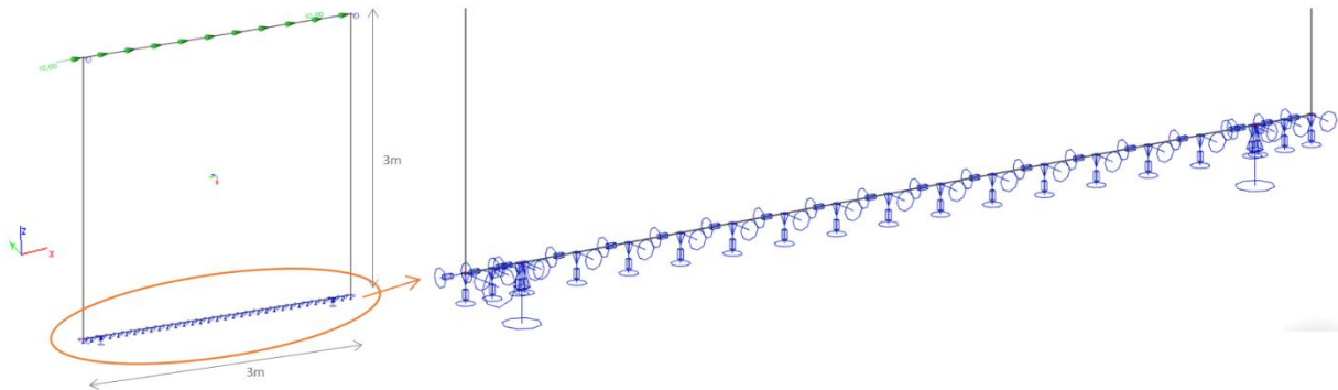
Figure 31 – Configuration des appuis pour le cas 3
