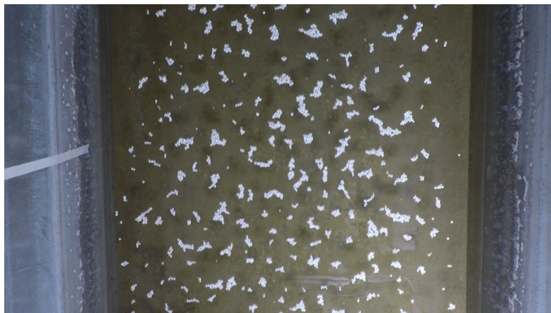
Figure 52 : Illustration du flou de mouvement : pour cette image, le débit étant faible, les traceurs apparaissent comme des billes bien nettes
