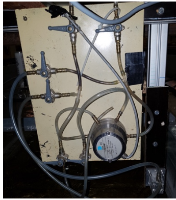
Figure 29 : Capteur de pression différentiel du tube de Pitot
