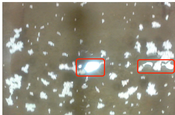
Figure 48 : Reflets lumineux visibles à la surface de l'écoulement
