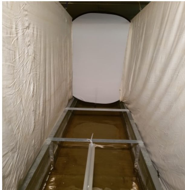
Figure 43 : Amélioration de l'illumination de la zone d'étude à l'aide d'un panneau et de draps réfléchissants
