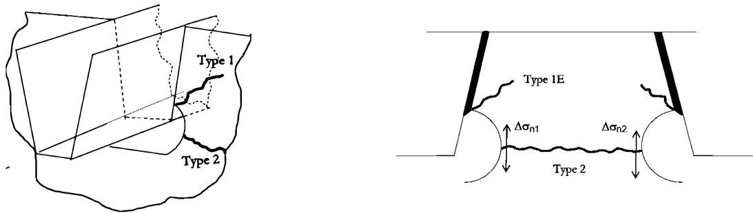
FIGURE 5.13 – Fissures dans l'âme de l'entretoise [4].
