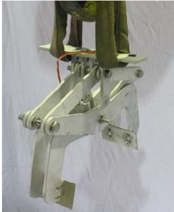
FIGURE 6.8 – Pince de levage adaptée aux blocs de maçonnerie drone-compatibles
