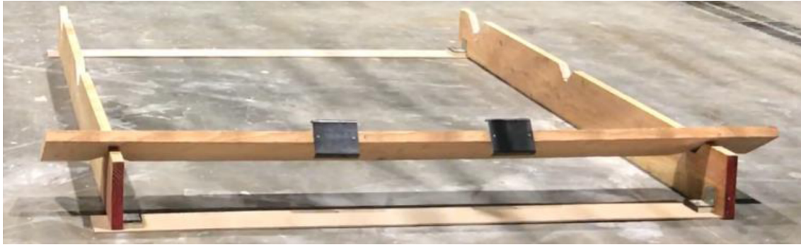
FIGURE 6.6 – Poutre en bois munie de plaques métalliques
