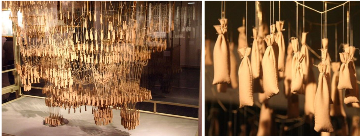
FIGURE 2.1 – Maquette polyfuniculaire suspendue, réalisée par Antoni Gaudi pour la conception de l'église de la Colonia Güell (1898-1914)
