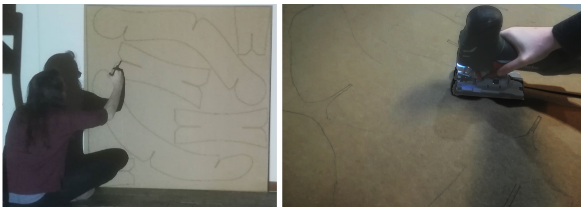
FIGURE 6.10 – Décalquage du fichier de découpe à l'aide d'un projecteur (à gauche) et découpage la scie sauteuse (à droite)
