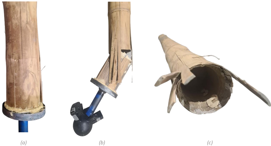
Figure 4.15 – Rupture du buton T18 au niveau de son assemblage et sa section la plus faible (a) à la fin de l'essai, (b) après l'essai, (c) l'intérieur du buton T18 creusé pour accueillir l'assemblage
