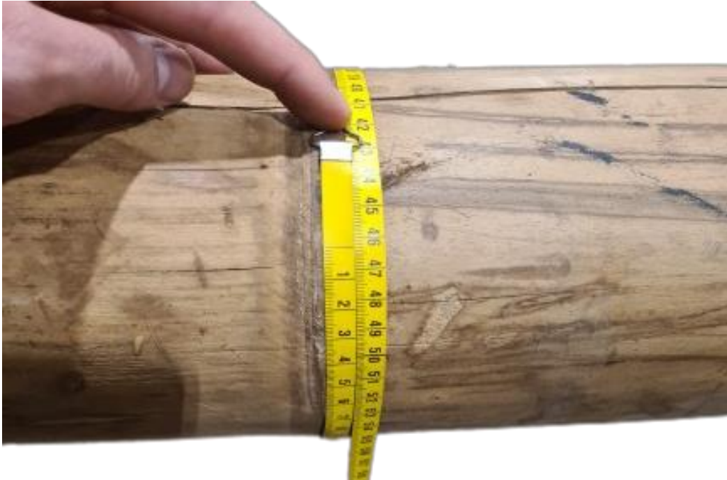
Figure C. 5 – Mesure du périmètre d'un nœud
