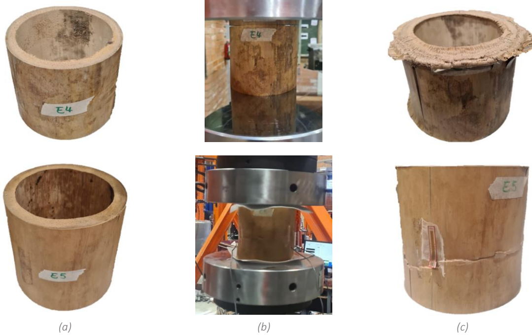
Figure D.4 – Photos des échantillons (a) avant, (b) pendant et (c) après l'essai de compression simple jusqu'à la rupture
