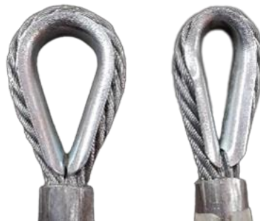
Figure 4.30 – Allongement des cosses à la suite de l'essai de mise en tension À gauche, la cosse initiale ; à droite, la cosse allongée
