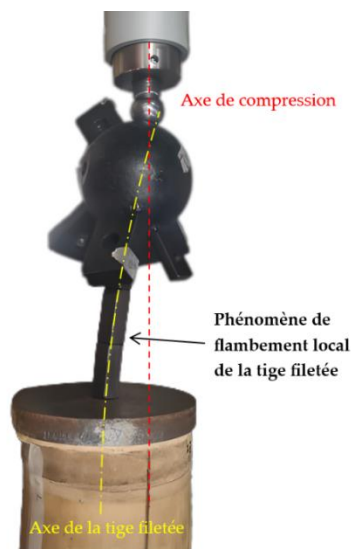
Figure C. 10 – Flambement de la tige d'assemblage
