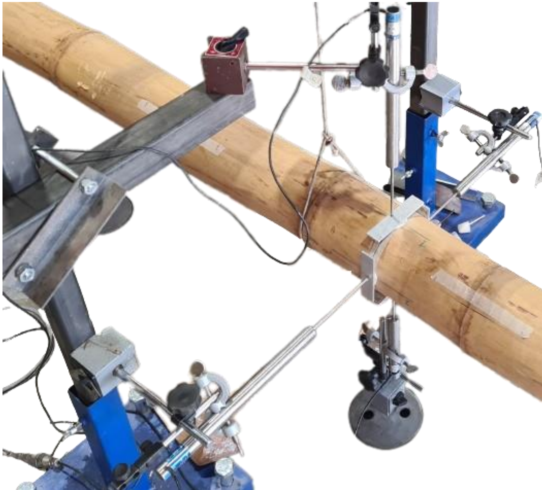
Figure C. 8 – Instrumentation de l'essai de flambement : 4 capteurs de déplacement LVDT (Linear Variable Differential Transformer) d'une course minimum de 100 [mm]
