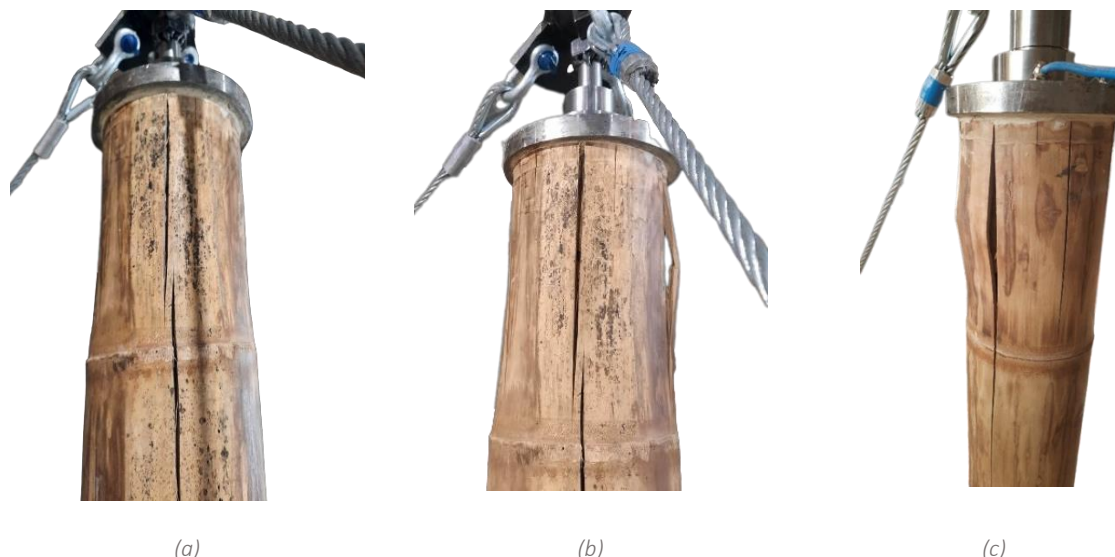
Figure 5.13 – Assemblage bouton T8 et nœud n°10 : (a) avant la rupture, (b) après la rupture (même vue que (a)), (c) après la rupture (vue du dessous)
