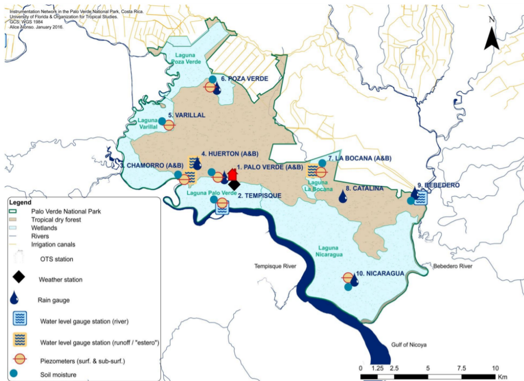
Figure 5 - 1 : Position des piézomètres, la station météorologique (losange noir) et la station OTS (maison rouge) et les six lagunes du la zone humide de Palo verde (Alonso, 2017).
