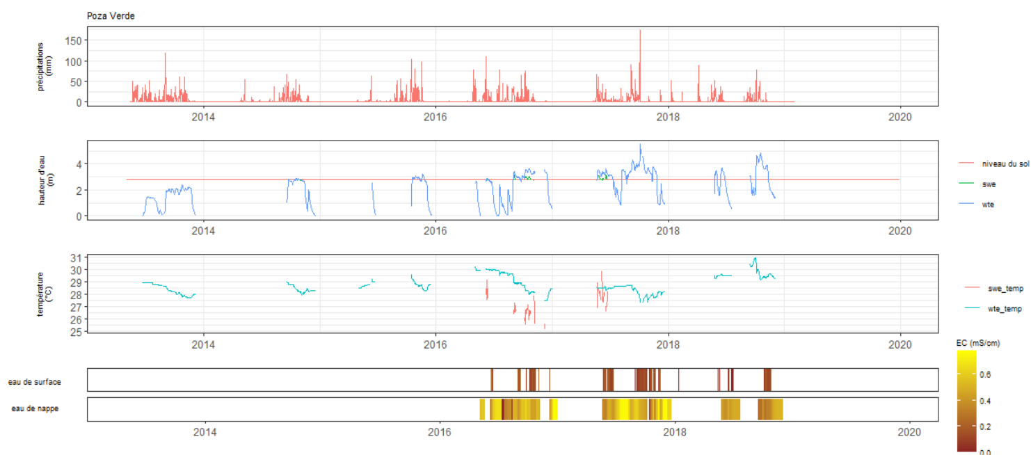
Figure 6 - 9 : Evolution des précipitations, du niveau des eaux souterraines et de surface, de la température et de la salinité (mS/cm) de ces dernières à Poza Verde (agrégées par jour).
