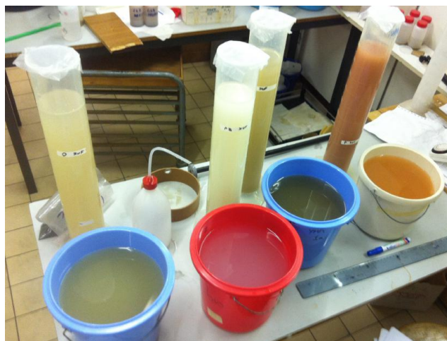
FIGURE A.21 – Granulométrie dans les laboratoires de l'UCL avec de gauche à droite : le lixisol, le paléosol blanc, le cambisol et le paléosol rouge.
