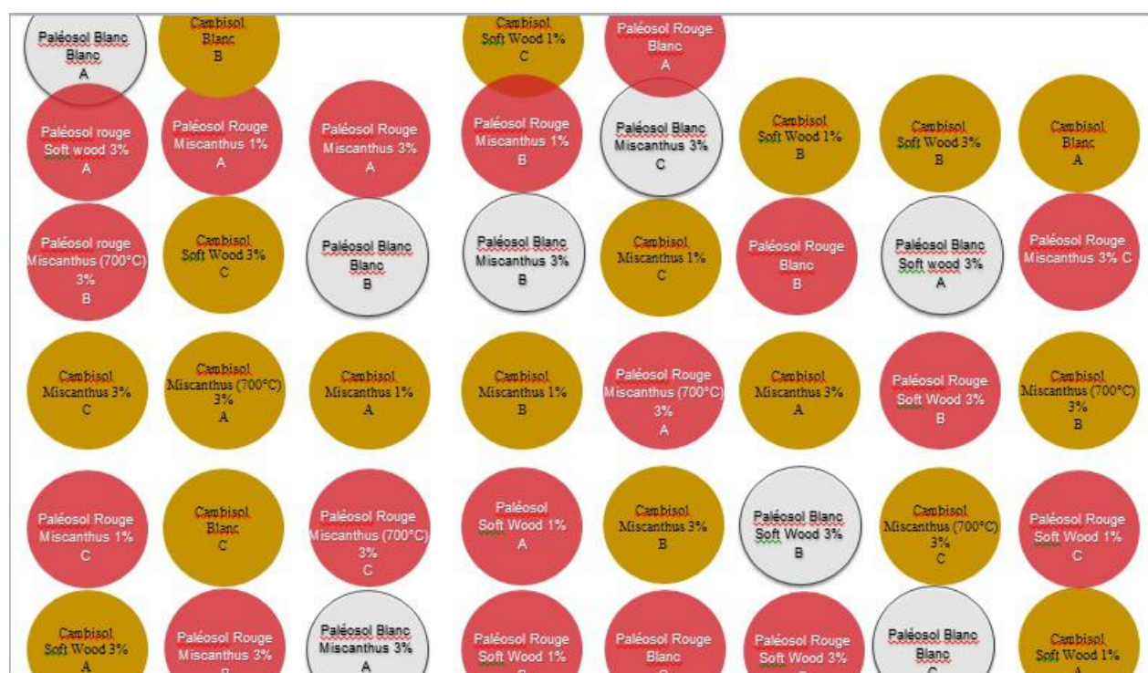
FIGURE B.2 – Schémas de la disposition des pots dans le phytotron. Les 4 bords de l'image représentent approximativement les murs du phytotron. L'entrée du phytotron se situe au centre-en bas de l'image ; les disperseurs d'eau sont au nombre de deux, en hauteur sur le mur droit (droite de l'image) ; le ventilateur est au centre de la pièce et de l'image.
