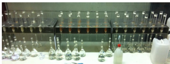
FIGURE A.22 – Colonnes de percolation utilisées pour déterminer la CEC.
