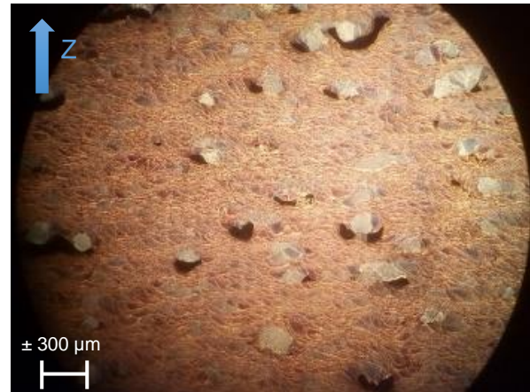
Figure 4-20 : Optique - Bains de fusion et porosités après une attaque au réactif de Keller
