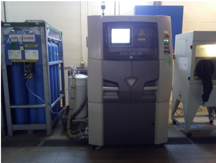
Figure 4-1: Imprimante ProX DMP 200 et ses bombones d'argon
