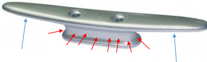
Figure 3-2 : Schéma de principe des chargements : en rouge force radiale sur le pied (40 000 N) et en bleu force verticale sur les ailes (4 000 N)
