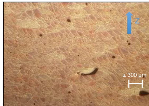
Figure 6-9 : Bains de fusion et porosités, image optique de l'échantillon (●) attaqué au réactif de Keller
