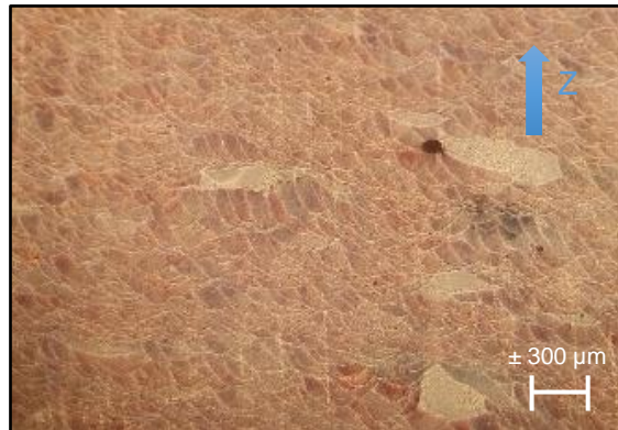
Figure 6-8 : Bains de fusion et porosités, image optique de l'échantillon (▲) attaqué au réactif de Keller
