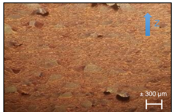
Figure 6-6 : Bains de fusion et porosités, image optique de l'échantillon (▲) attaqué au réactif de Keller
